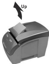
1 - Alzare la leva dell'apertura del coperchio;
